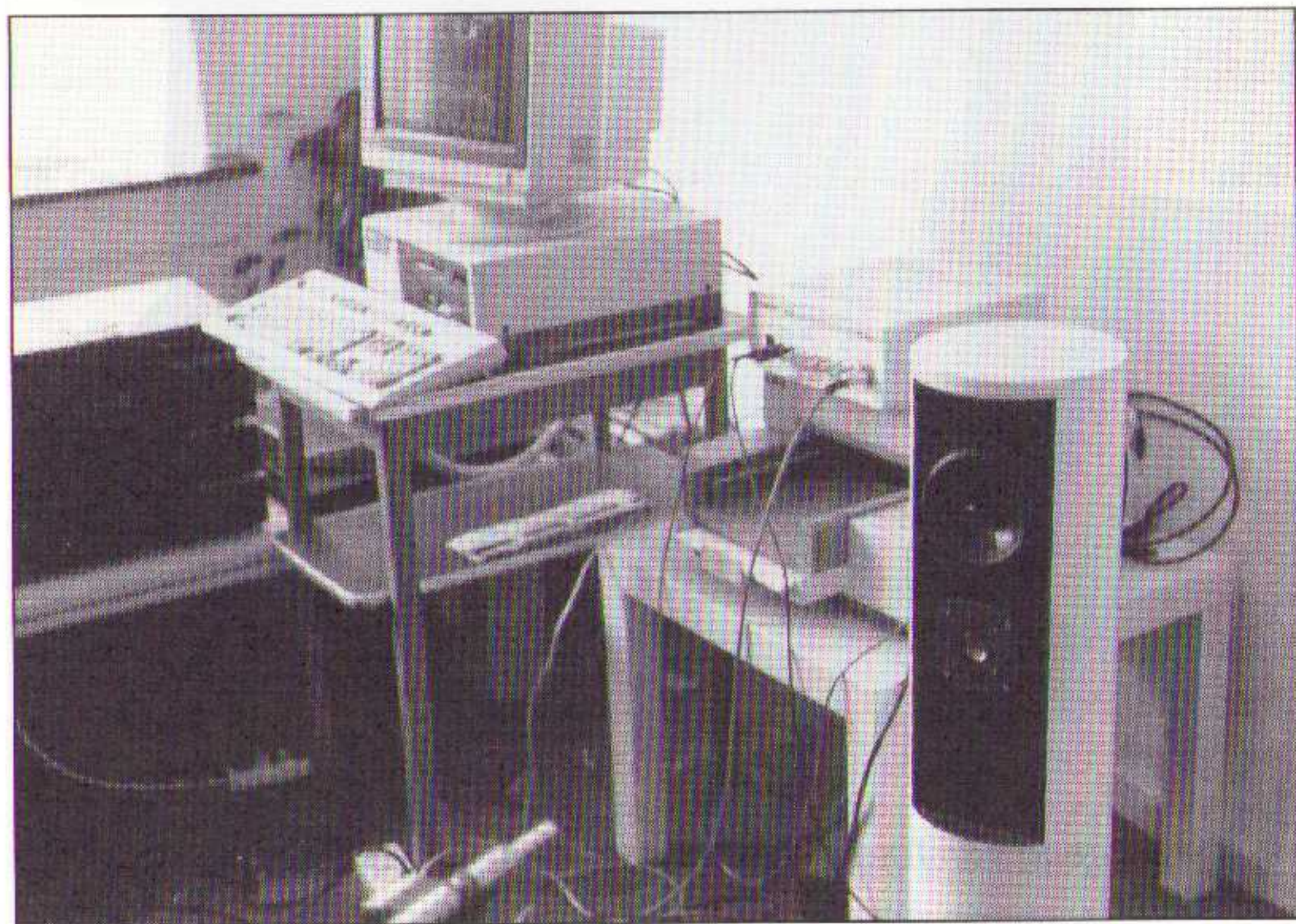
De meetopstelling. Geheel links is de gebruikte AT-computer te zien. Rechts daarvan een HP deskjet waarop de grafieken uitgeprint werden en daar bovenop de Kemtec AMS PC-1656. Rechts daarvan de nieuwe L-40 met daarvoor de meetmicrofoon.
